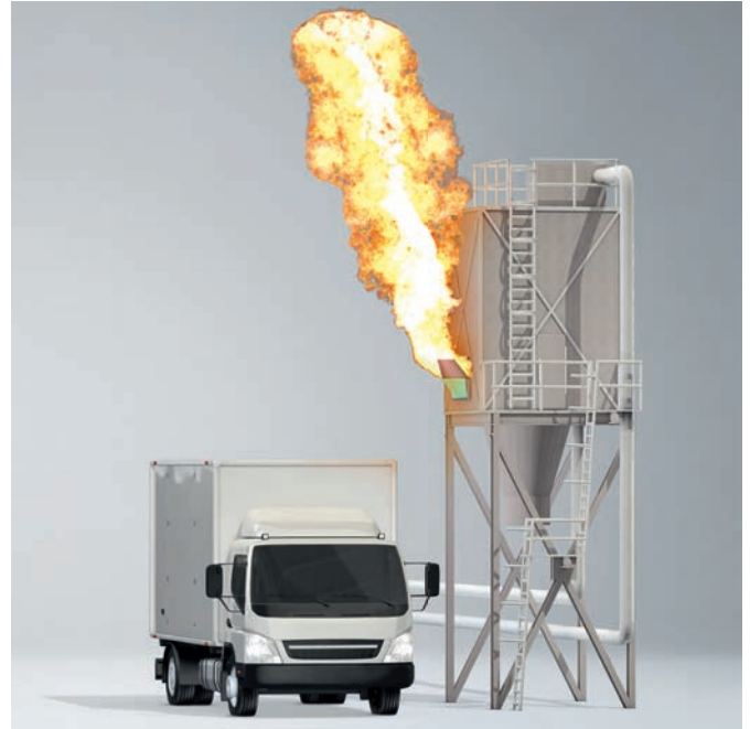
Mit TARGO-VENT: Die Flamme wird in sichere Bereiche gelenkt.
